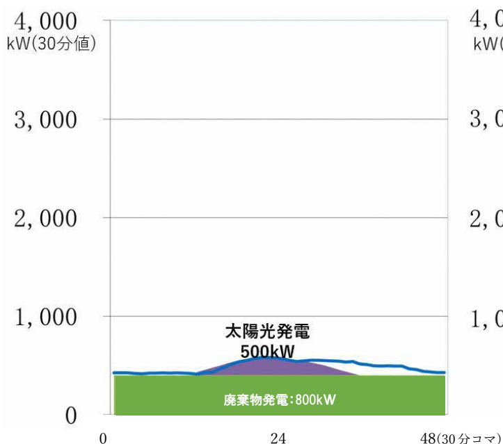
図4-7 5月休日廃棄物発電+太陽光電源導入
